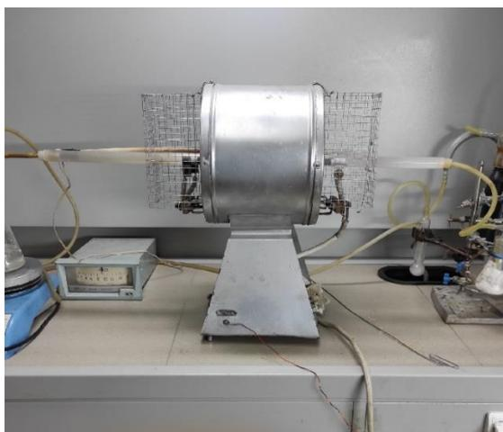
Рисунок 5 - лабораторная установка для определения общей серы в нефтепродуктах методом сжигания в трубке
